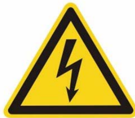
Рисунок 1 – Предупреждающие символы, обозначающие наличие цепей напряжением 220В
