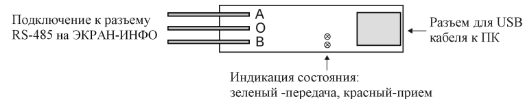
Рисунок 6. Расположение контактов преобразователя ПИ1.
