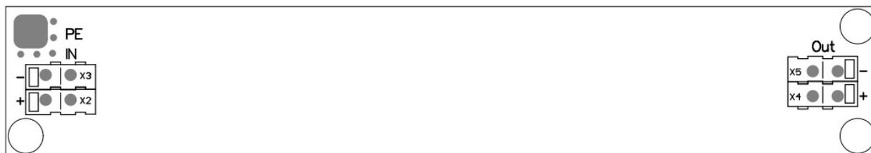
Расположение клемм на плате светильников ЗЕНИТ МК-20-220
