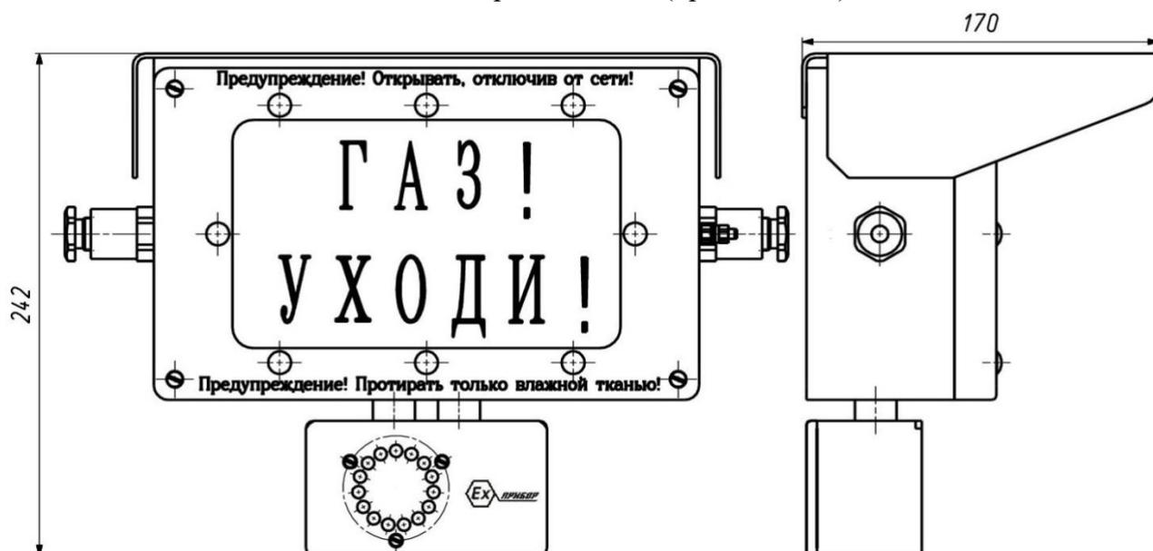
Рис.В.5. Светозащитный козырек для табло ExTK-2
